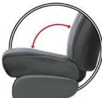
Figura 2 - Inclinação do encosto do banco deve ser de 100 a 120°.
