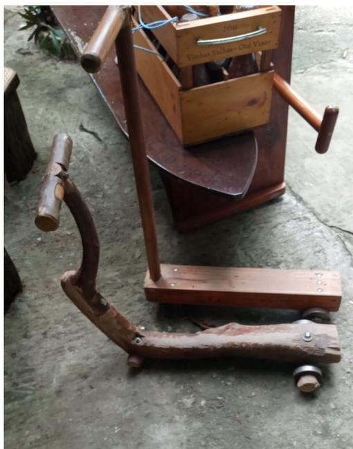
Figura 4: patinete modelado a partir de um tronco de goiabeira. Fonte própria, 2020.
