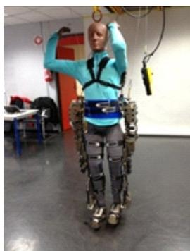
Figure 1 - Exoskeleton.
