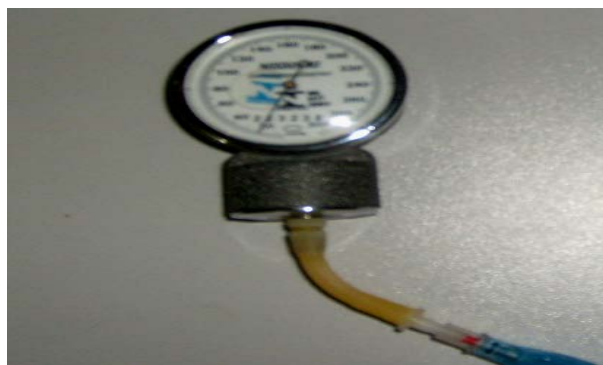
Figura 1: Manômetro adaptado à extremidade de um equipo de soro para verificação da pressão do cuff .
